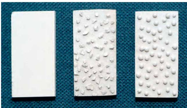
Fig. 7: Provini con superfici in BioHPP preparate con differenti metodiche (a sinistra: fresate, al centro: con cristalli, a destra: con perle).<sup>8)</sup>
