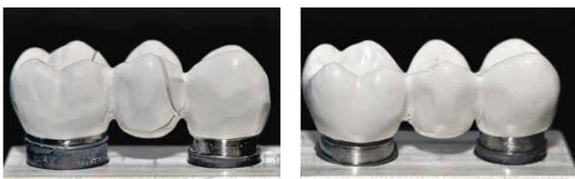
Fig. 23: A sinistra una frattura spontanea di un ponte fresato in breCAM.BioHPP, a destra una deformazione plastica di un ponte realizzato in BioHPP in granuli.<sup>28)</sup>
