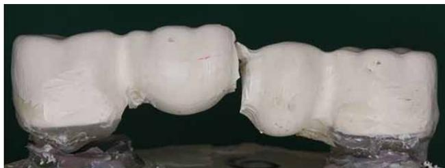
Fig. 33: Frattura di un ponte in BioHPP realizzato con tecnologia CAD/CAM.<sup>43)</sup>
