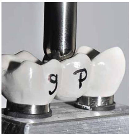
Fig. 19: Ponte in BioHPP durante il test.<sup>24)</sup>
