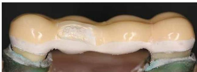
Fig. 39: Ponte dopo test di carico con chipping del rivestimento.<sup>52)</sup>
