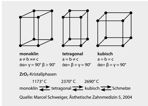
Die whiteSKY Implantate werden aus Zirkonoxid mit tetragonaler Struktur hergestellt. Diese Struktur bietet für die orale Implantologie die besten mechanischen Eigenschaften. In der Natur kommt diese Struktur nur bei Temperaturen zwischen 1173° C und 2370° C vor. Durch die Zugabe von Yttrium wird die Struktur bei Zimmertemperatur stabilisiert.
