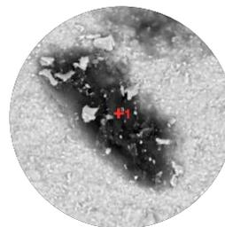
Zusammensetzung der Verunreinigungen auf Zirkon CAD-/CAM Abutment
