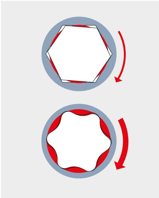
Bei Implantaten mit einer Sechskantverbindung wird die Kraft beim Eindrehen der Implantate von einer relativ kleinen Fläche übertragen, daher kommt es bei hohen Drehmomenten häufig dazu, dass der Eindreher im Implantat stecken bleibt.
