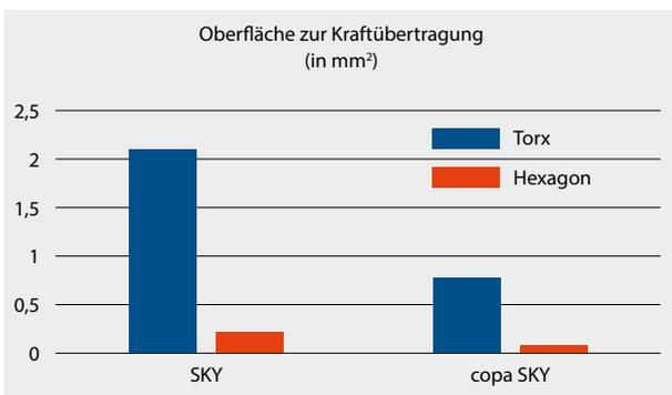
Die Fläche der SKY und copaSKY Verbindungen die für die Kraftübertragung zur Verfügung stehen im Vergleich zu der Fläche die theoretisch bei einem Hexagon zur Verfügung stehen würde.
