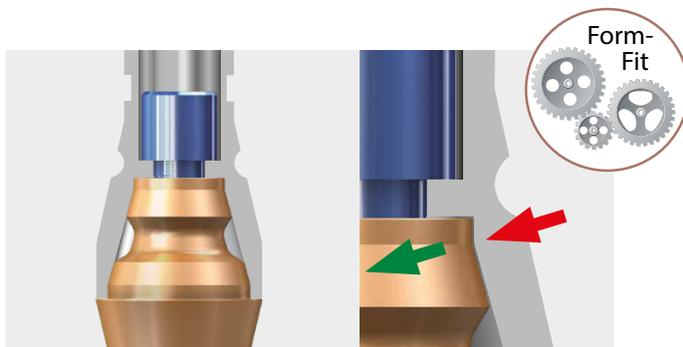
Hohe biomechanische Stabilität der okklusalen Verschraubung durch Form-Fit, ein auf Passgenauigkeit der Aufbauverbindung optimiertes Herstellungsverfahren. Die Übertragung der lateralen Kräfte erfolgt so direkt von der Brücke auf das Abutment, die relativ kleine Schraube wird nur wenig belastet und vor Lockerungen und Brüchen geschützt.
