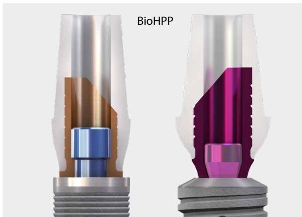
Das keramisch verstärkte High Performance Polymer BioHPP wurde speziell für die Zahnmedizin entwickelt. Durch die Compoundierung von PEEK mit Keramik entsteht ein Werkstoff mit optimalen Eigenschaften für die intra-orale Anwendung, biokompatibel physiologisch und langlebig. Dieser Werkstoff wird in einem patentierten Verfahren direkt auf die Basis gespritzt, so dass ein spaltfreies monolithisches Hybridabutment entsteht.
