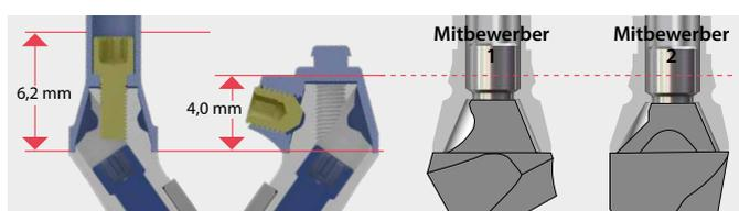
Für eine gute Führung bei der Insertion verfügen die SKY fast & fixed und SKY uni.cone Abutments über einen relativ hohen Konus, dennoch lassen sich mit der transversalen Fixierung konkurrenzlos niedrige Versorgungen herstellen, z.B. für den Seitenzahnbereich.
