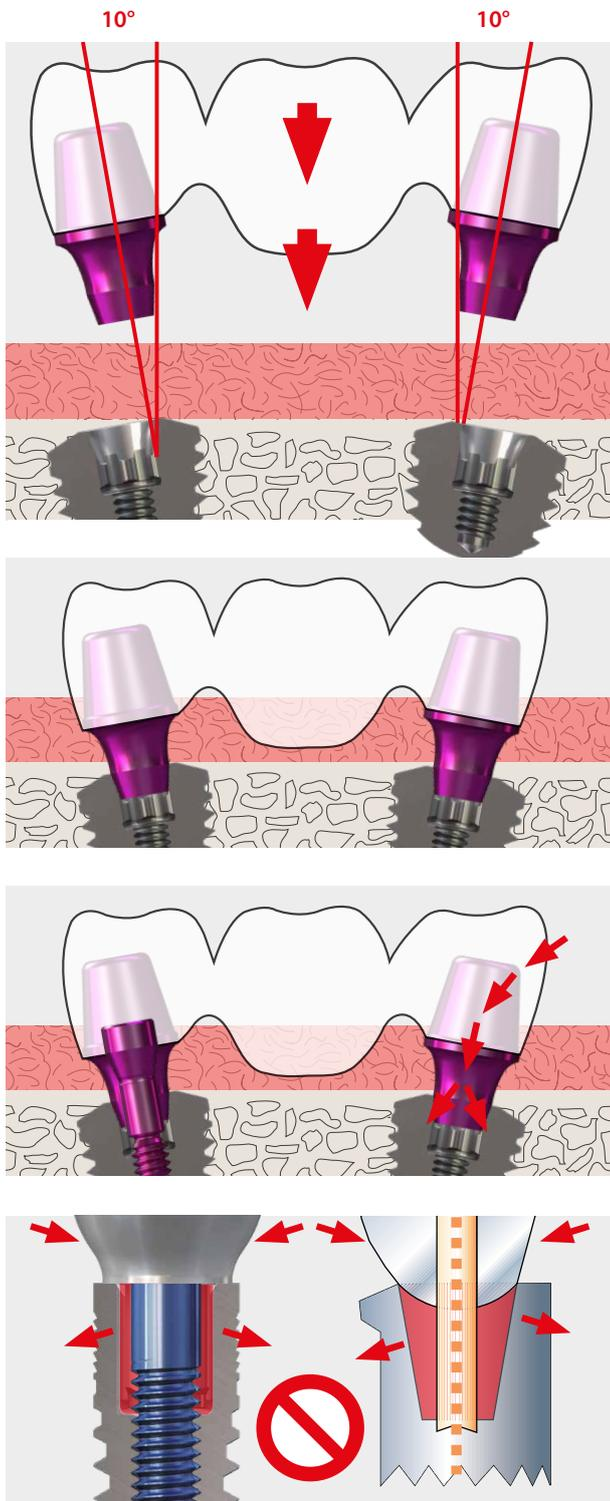
Der relativ flache Konus des copaSKY Implantats ermöglicht einen Angulationsausgleich von bis zu 20°.
