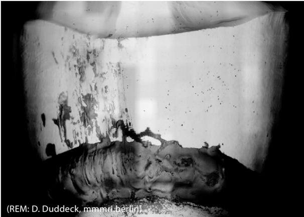
REM-Aufnahmen des submukösen Bereichs eines Hybridabutments
