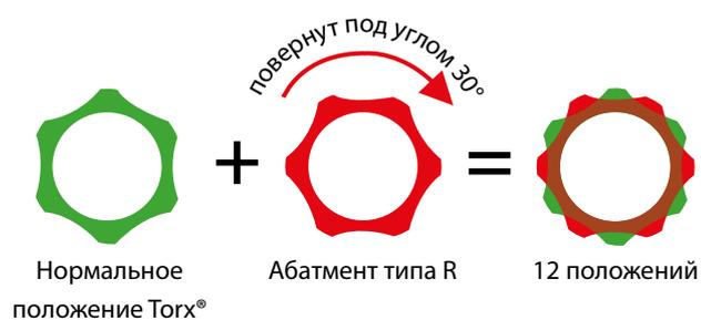
Исполнение R с возможностью установки в 12 положений для оптимального выравнивания ангулированных абатментов с целью эффективной индивидуальной подгонки.
