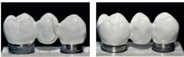
Рис. 23: Слева спонтанная фрактура фрезерованного моста из breCAM.BioHPP, справа пластическая деформация моста, изготовленного из таблеток BioHPP.<sup>28)</sup>
