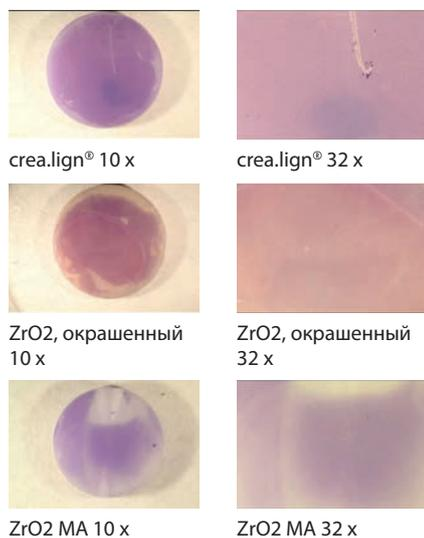
Рис. 47: Увеличенное изображение образцов испытываемой партии для определения бактериального покрова *S. gordonii*.<sup>65)</sup>
