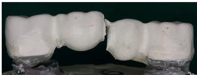
Рис. 33: Фрактура моста, изготовленного из BioHPP посредством системы CAD/CAM.<sup>43)</sup>
