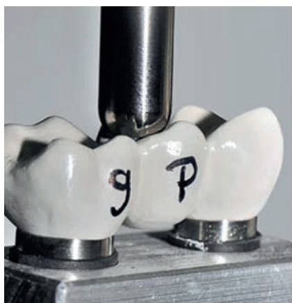
Fig. 19: Puente de BioHPP durante el ensayo. 24)
