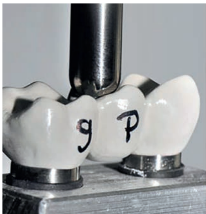
Abb. 19: BioHPP®-Brücke während der Prüfung. 24)
