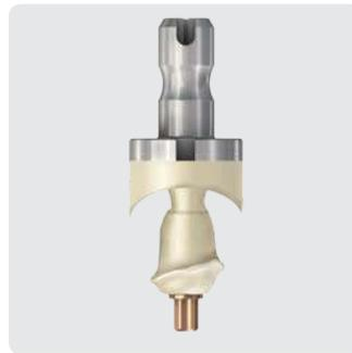
Beim BioHPP SKY elegance prefab ist der Abutmentkörper aus BioHPP spaltfrei auf die BioHPP SKY elegance Titanbasis aufgedrückt und bildet eine perfekte mechanische Verbindung. Die gewünschte zahnanaloge Form des individuellen Abutments wird in einer CAD Software konstruiert und der entsprechende Datensatz zur maschinellen Fertigung weitergegeben.
