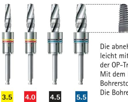
Die abnehmbaren Bohrerstopps sind so angeordnet, dass sie leicht mit dem Bohrer aufgenommen und mit den Kavitäten in der OP-Tray-Einlage mit einer Hand befestigt werden können. Mit dem Lineal auf dem Fach für Kleinteile kann die Wahl des Bohrerstopps leicht und schnell überprüft werden. Die Bohrertiefe ist ca. 0,7 mm tiefer als die Implantatlänge.
